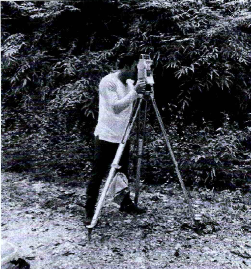
Foto 1: Colocación, Nivelación y ajuste de Estación Total Geomax para Levantamiento Topográfico
