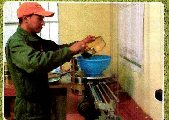
Ensayos: granulometría de áridos, abrasión, compactación, diseño de mezclas, compresión de cilindros, adoquines, calificación de materiales.
