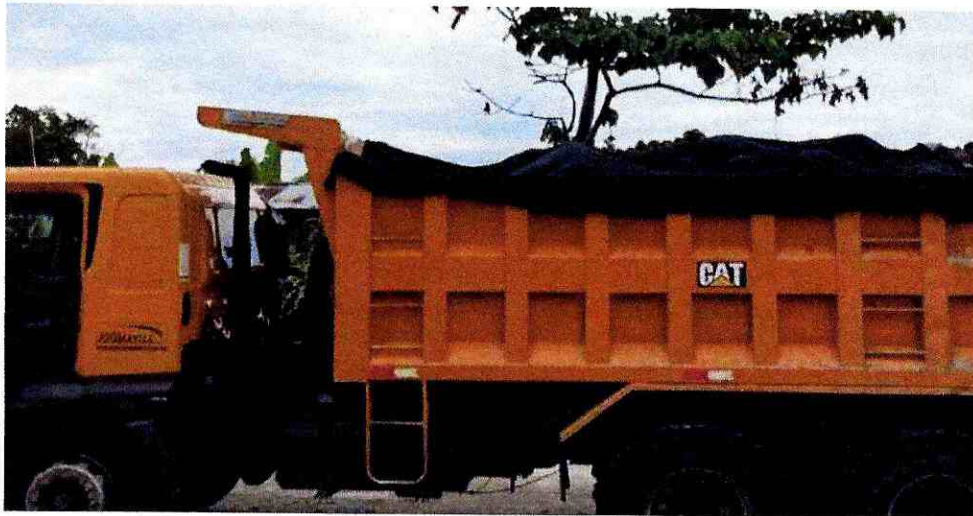
LONAS DE CUBIERTA EN VOLQUETA
