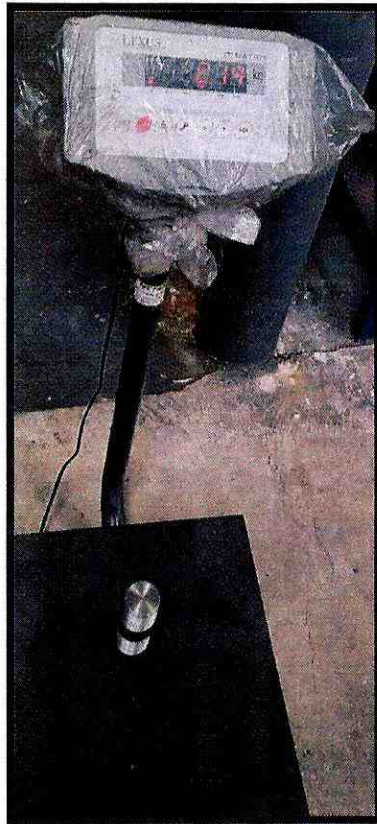
Fotografía 5. Revisión de peso de las partes metálicas las mordazas de las péndolas antes del proceso del mecanizado: roscado o acanalado
