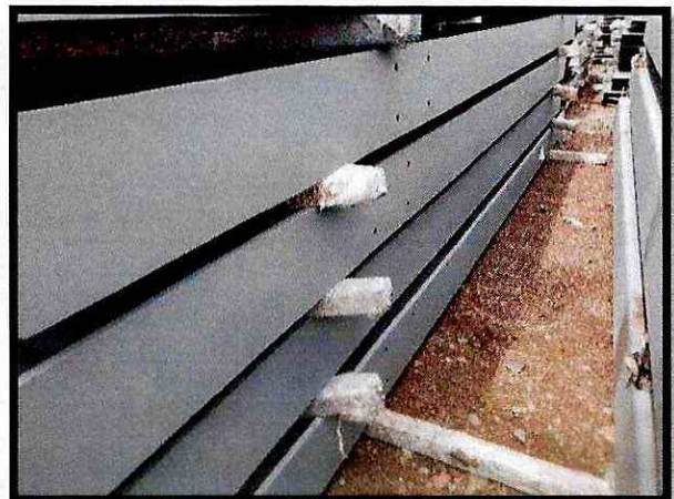
Fotografía 4. Revisión dimensional, acabados superficiales y proceso de soldadura en componentes de las mordazas para las péndolas.
