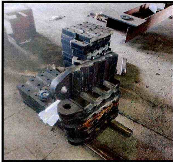
Fotografía 4. Revisión dimensional, acabados superficiales y proceso de soldadura en componentes de las mordazas para las péndolas.
